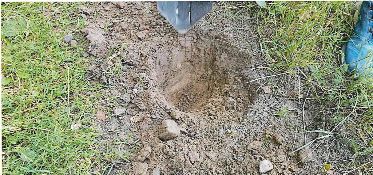
*Abbildung 3 Schottertragschicht unterhalb verunreinigter Bodenschicht
